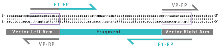
图4. 设计引物将插入片段克隆到PCR扩增得到的线性化载体中。
